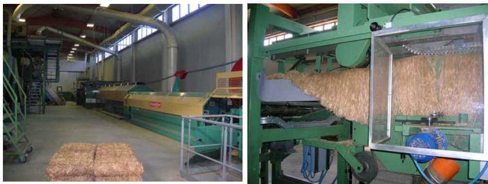
Figura 4.2-8. Impianto di stigliatura e pettinatura di Ecocanapa, Comacchio (FE) (Foto S.Baronti)
