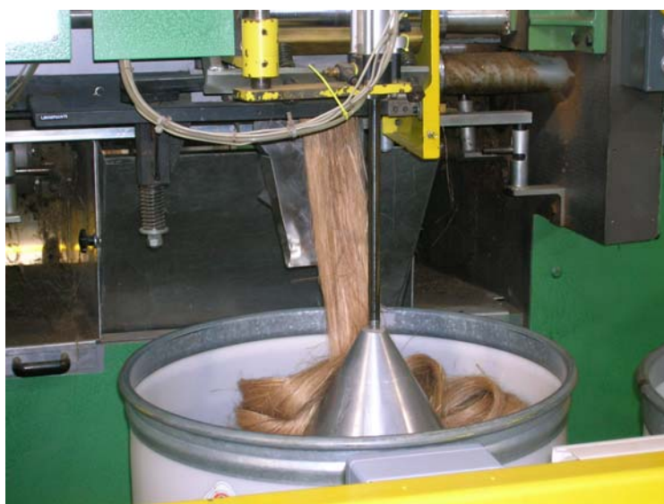
Figura 4.2-9. Impianto di pettinatura (particolare) di Ecocanapa, Comacchio (FE) (Foto S.Baronti)
